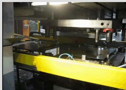
Движение между двумя прессами с использованием линейного устройства.
